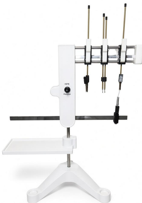
Рис. 2. Механическая часть миографа (штатив, коромысло, зажимы, электроды)
